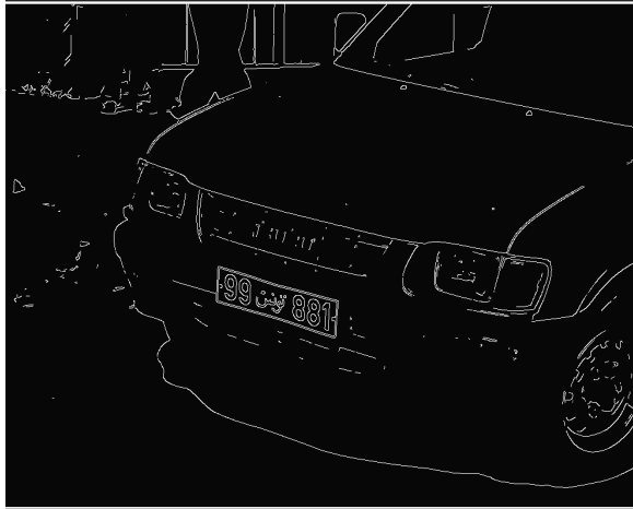
Figure 5. l'application de l'algorithme de Canny sur une1ère image en niveau de gris.
